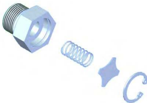
Рисунок 2-23 Чертеж противопенного обратного клапана в разобранном виде
