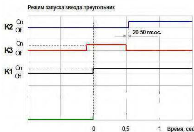
Рис. 5-3 (b) Принципиальная схема пускового контактора с задержкой по схеме «звезда-треугольник»
