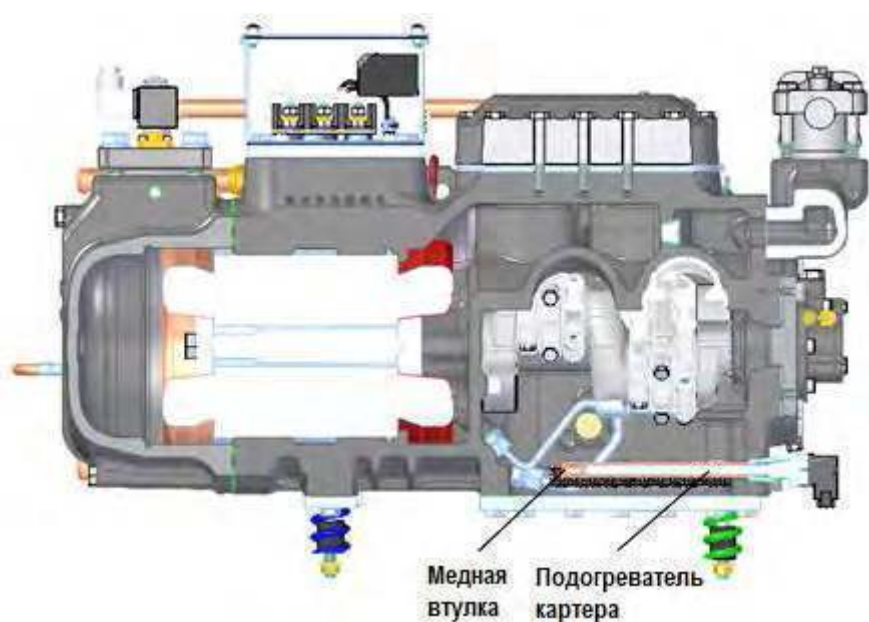
Рисунок 2-8 Нагреватель картера серии SBC
